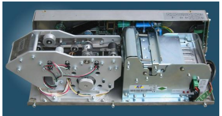
Il gruppo di codifica magnetica AEP - AEP magnetic encoder
