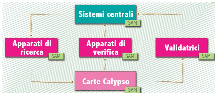
Calypso definisce esattamente i colloqui terminale/carta e terminale/modulo SAM, nonché le varie operazioni di crittografia necessarie per conseguire gli scopi sopra elencati.
