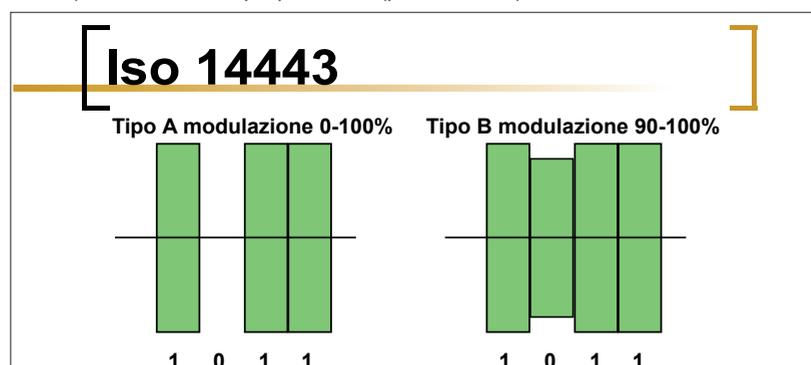
Questo determina un trasferimento di energia ridotto: quando si trasmette uno “zero” il trasferimento di energia è nullo. L'energia trasferita non risulta adeguata, in genere, al funzionamento delle carte a microprocessore. Per questo motivo è stato ideato lo standard del tipo B che ovvia a questo inconveniente.
