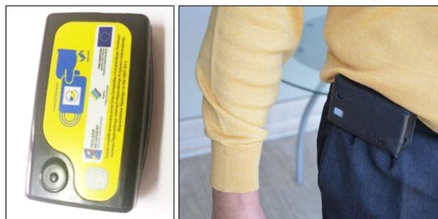
La soluzione detta MOB, dal nome di ET-MOB, è quella tradizionalmente offerta da AEP prima dell'introduzione di CDB-4 PLUS (mostrato nella foto sotto), cui si affianca. Prevede l'impiego di un telefono cellulare in connessione Bluetooth con il lettore contactless e con un'eventuale stampante, indossati alla cintura dal controllore come mostrato nel particolare. Visibile anche il lettore TPV nella livrea di KZK-GOP e il particolare della borsa in pelle a cintura.
