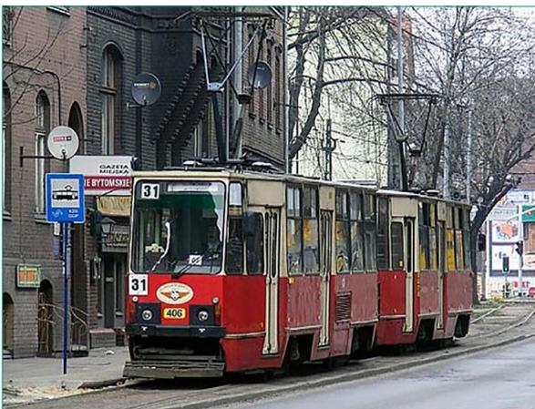
Nella regione Slesia sono tuttora in funzione anche vetture tranviarie delle precedenti generazioni. Per questo motivo il progetto del SDB ha dovuto tener conto di impianti particolari, ad esempio con la tensione di alimentazione servizi a 40V.
